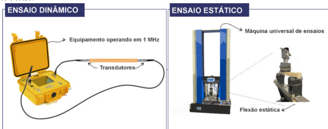
Figura 1: Esquema de ensaio dinâmico (propagação de ondas ultrassônicas) e estático (flexão estática) para madeiras de eucalipto e cedro.
