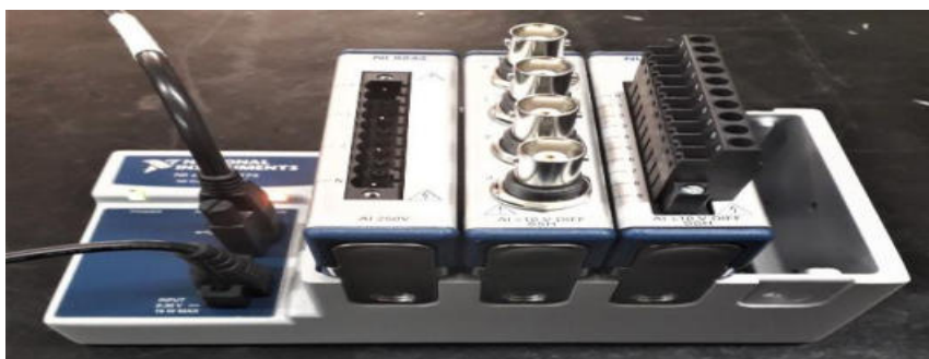
Figura 2. Sistema modular de aquisição de dados composto por dois módulos.
