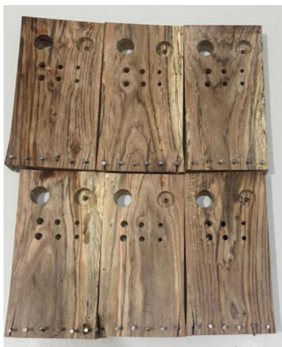
Figura 2: Resultado dos corpos de prova após realização dos testes de usinagem.
